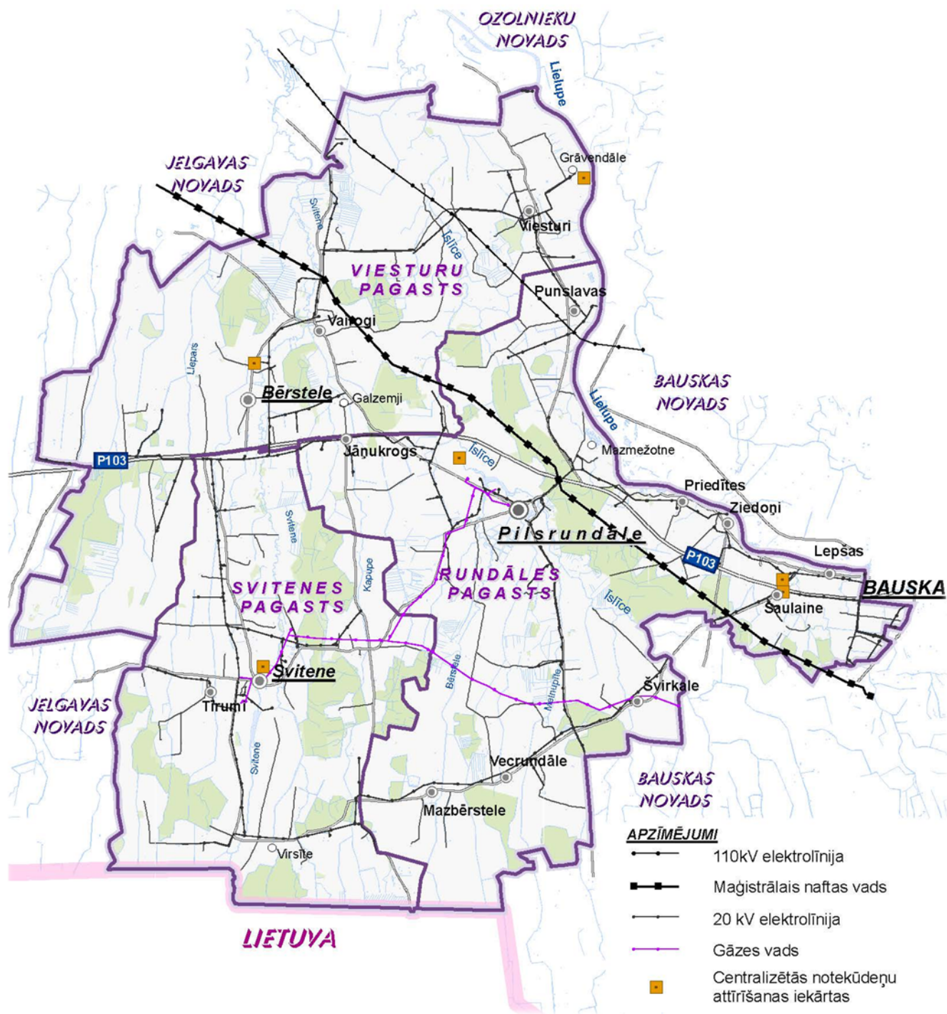
58. attēls. „Tehniskā infrastruktūra”.
