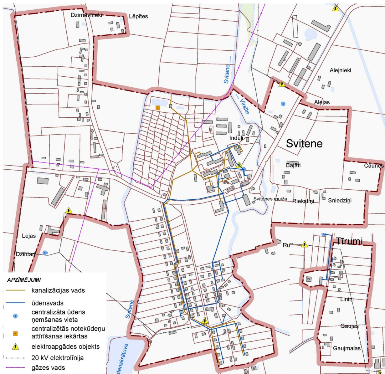
57. attēls. „Svitenes un Tirumu ciemu ūdensapgādes un kanalizācijas infrastruktūra”.
