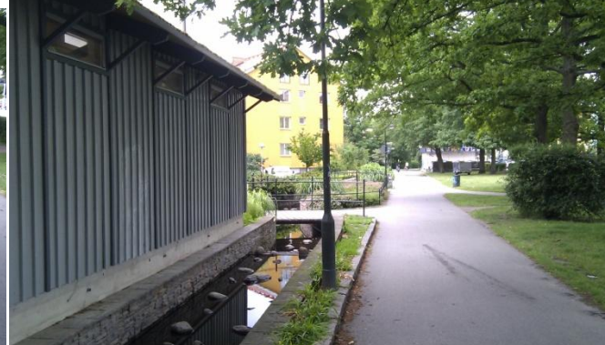
43. attēls. Kanāla novietojums Lonngatan ielas telpā. Kanālā ievietoti laukakmeņi, kas sekmē ūdens aerāciju. Avots: autoru arhīvs
