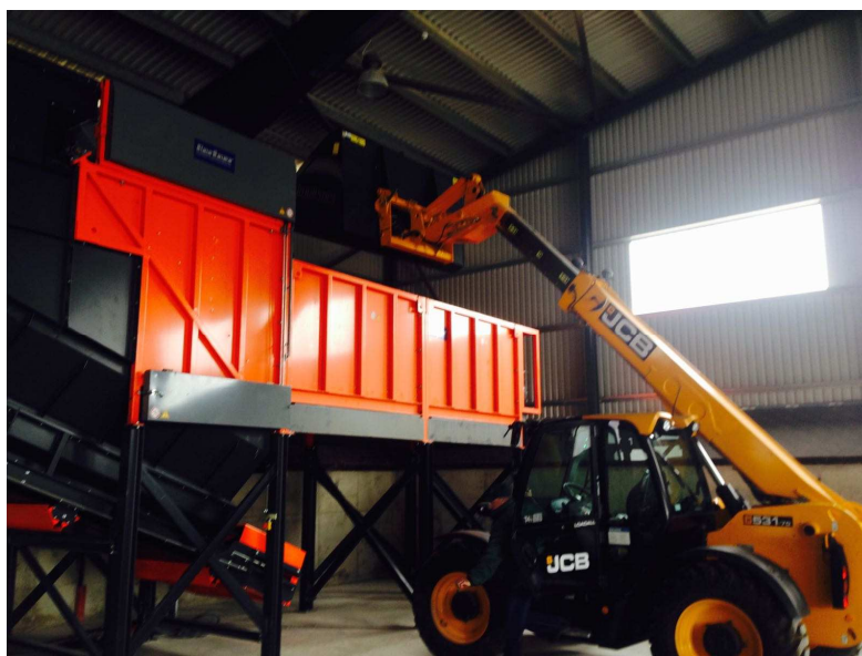
2.7.attēls. Frontālais iekrāvējs ieber atkritumus maisu atvēršanas iekārtā
