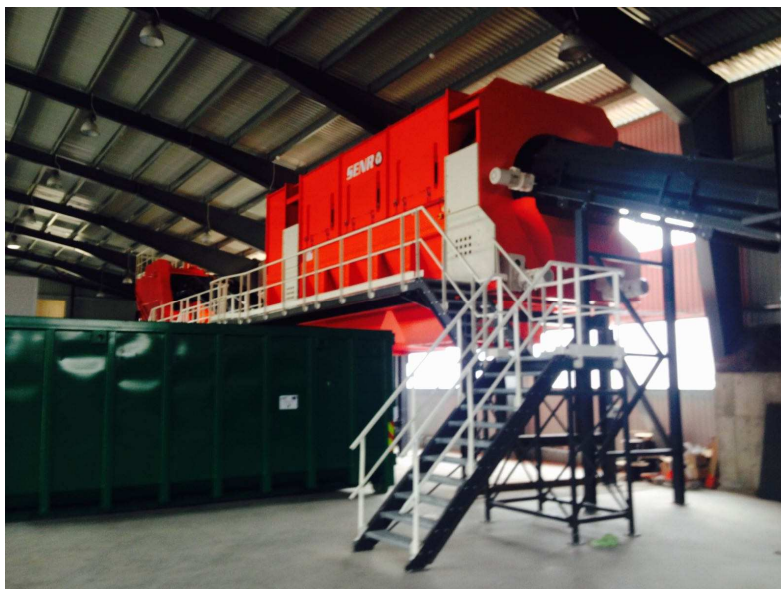
2.8.attēls. Atkritumu smalcināšana rotora tipa sijāšanas mehānismā un atšķirotu bioloģiski noārdāmo atkritumu savākšanas konteiners
