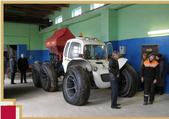
Minskā eksperimentālajā rūpnīcā ražots atvieglotais visurgājējs minerālmēslu izsējai un lauku miglošanai. Jauna veida mīkstās bezprotektora riepas, veicot lauku apstrādi sējumiem, nenolauž un neiemīca zemē asnus, līdz ar to visurgājējs var strādāt bez tehnoloģiskajām slīdēm/ Foto: Ojārs Baltniņš/
